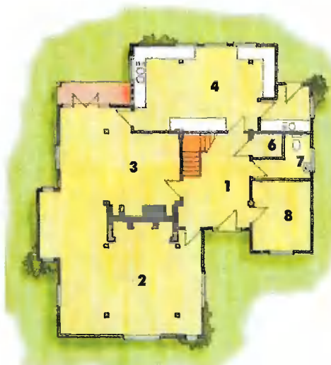
Первый этаж: 1 — холл; 2 — гостиная; 3 — столовая; 4 — кухня; 5 — кладовая; 6 — гардероб для верхней одежды; 7 — туалет; 8 — кабинет
