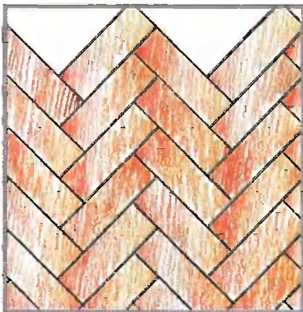
Рис. 2. Укладка этих же камней по схеме «в елочку». Камни имеют форму обычного кирпича
